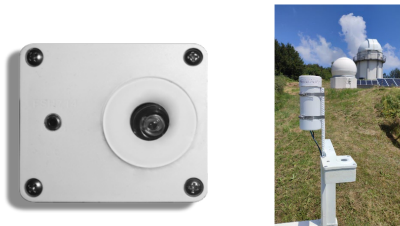
Слика 5. Изглед TESS-W фотометра (лево) и TESS-W фотометар монтиран на стубу на АСВ у предњем плану, иза се види Унихедрон Sky Quality Meter - модел SQM-LE док су у позадини куполе 40 см и 1.4 м телескопа.
