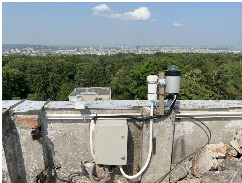
Слика 6. TESS-W (лево), унихедрон (у средини) и all-sky камера (десно) на врху Куле са погледом на панораму града.
