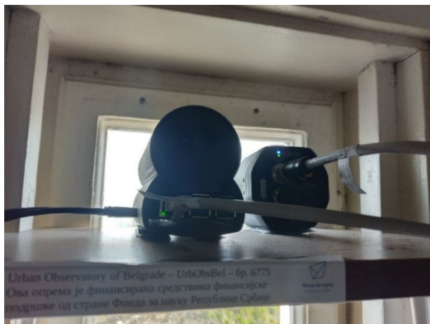
Слика 3. HSI уређај (лево) и FLIR A700 термална камера (десно) постављени на Кули Астрономске опсерваторије.
