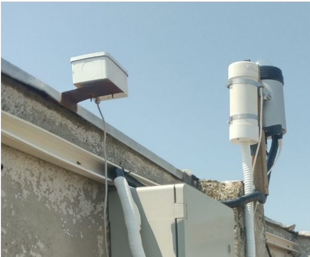
Слика 4. Уређаји монтирани на тераси Куле Астрономске опсерваторије (са лева на десно): TESS-W фотометар, SQM-LE уређај и all-sky камера Alcor OMEA 3C.
