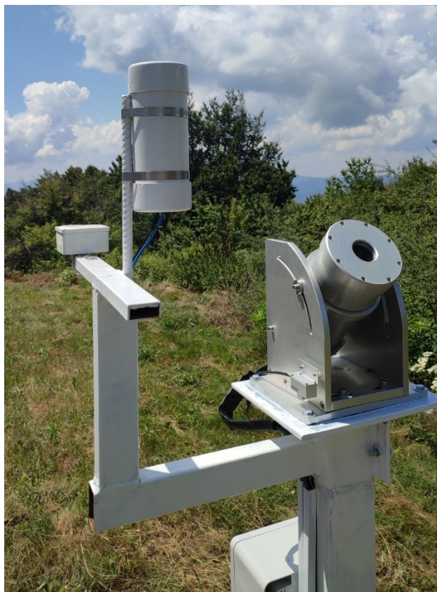
Слика 5. Уређаји монтирани на Астрономској станици Видојевица: TESS-W фотометар (лево) и SQM-LE уређај (у средини). Уређај на десној страни је тзв. „seeing“ монитор и монтиран је за потребе рада Астрономске станице.
