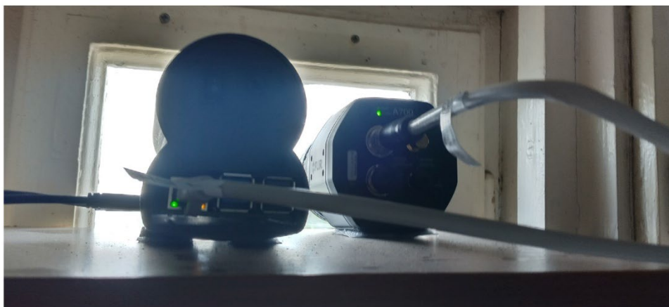
Слика 6. HSI хиперспектрални уређај (лево) и FLIR A700 термална камера (десно) монтирани на Кули Астрономске опсерваторије.
